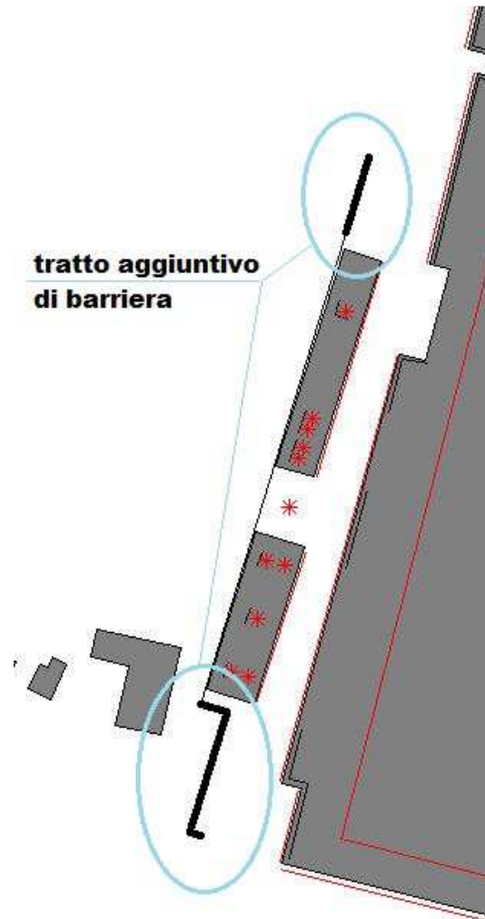
Estensione in senso longitudinale della barriera
